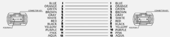
Belegung des Trunkkabels 12-fasrig
