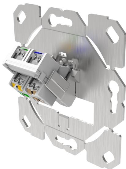
Abbildung 1: Werkzeuglose Beschaltung des Moduls durch rückwärtige Schieber (Ansicht ohne Schirmungsblech und Trägerplatte)
