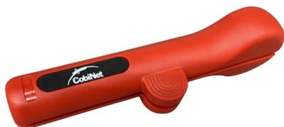
Für die Installation von RJ45-TL®-Buchsen empfiehlt CobiNet das Standard-Abmantelwerkzeug CobiNet CS1 (Art.-Nr.: 124725) mit einstellbarem Längenanschlag zum definierten Absetzen des Kabelmantels und Anritzen der Paarfolien für Netzkabel mit 3 – 10 mm Durchmesser.
